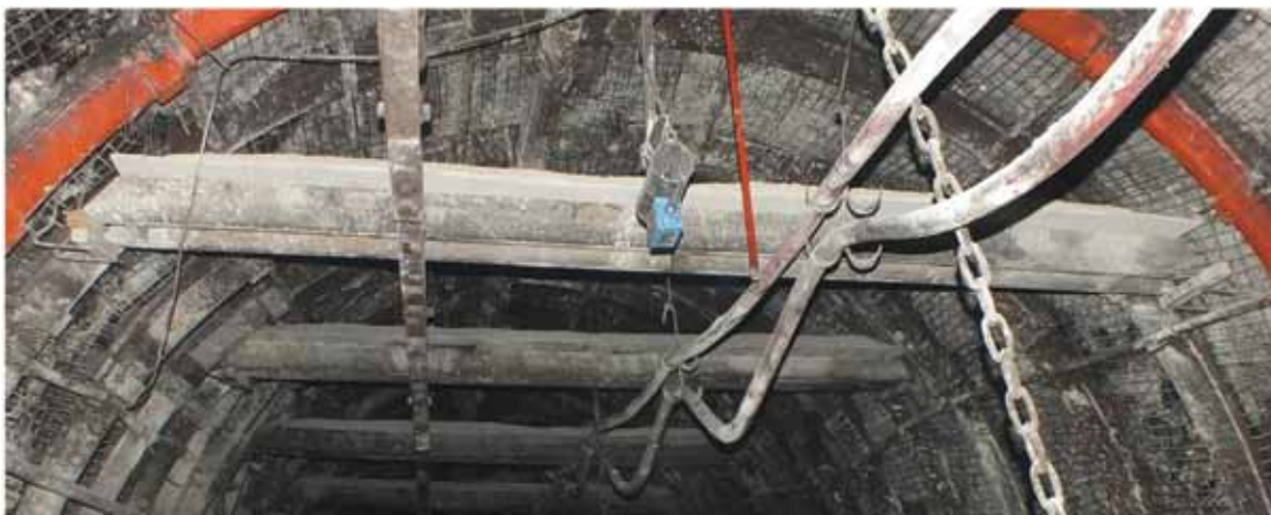
Rys. 1. Zapora przeciwwybuchowa pyłowa w wyrobisku górniczym
