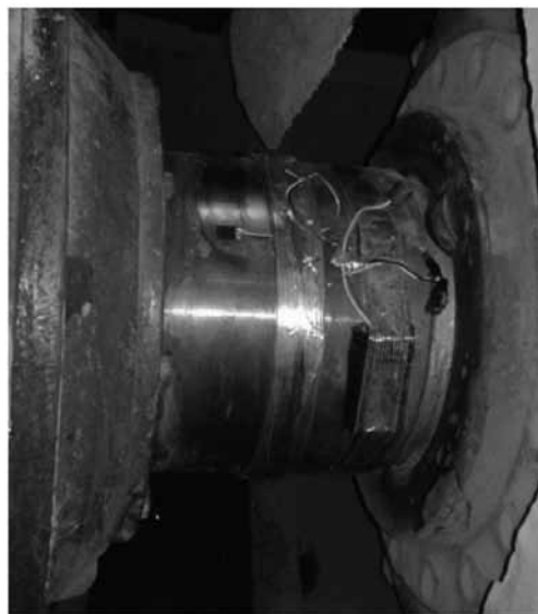
Rys. 5. Układ tensometryczny zamontowany na wale badanego silnika
