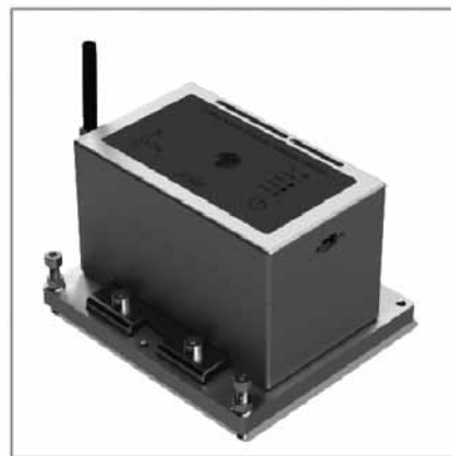
Rys. 5. Kopalniana Stacja Pomiaru Drgań – model 2012
