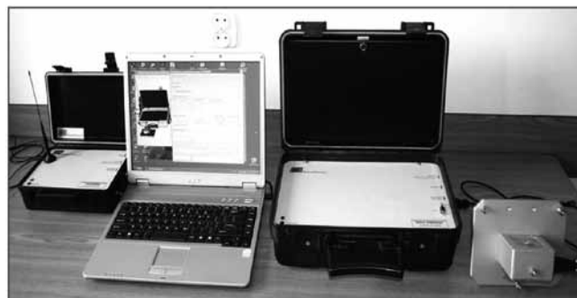
Rys. 3. Kopalniana Stacja Monitoringu Drgań (KSMD) – widok ogólny Opracowaniewłasne
