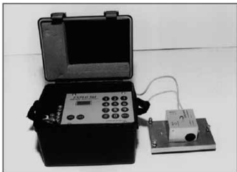
Rys. 2. Mała Stacja Monitoringu Drgań Explo 504 Opracowaniewłasne
