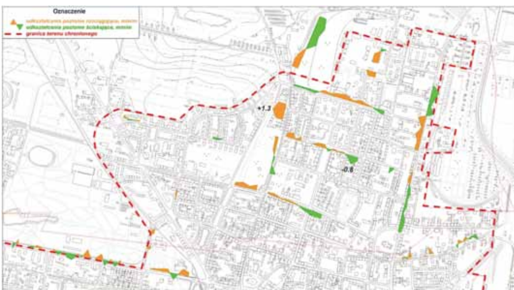
Rys. 7. Wykresy pomierzonych odkształceń poziomych za okres lat 2002÷2012 Fig. 7. Graphs of measured horizontal strains for the years 2002÷2012
