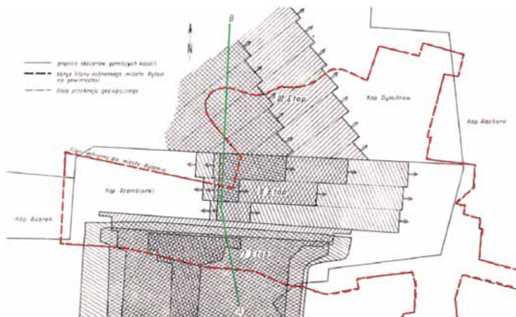
Rys. 3. Schemat eksploatacji w filarze ochronnym miasta Bytomia według założeń z 1950 r. [2]
