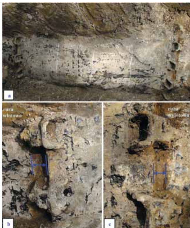
Fot. 4. Ślady rozsunięcia kompensatora gazociągu DN200 Photo 4. Traces of the pipe movement in the expansion joint of gas pipeline DN200
