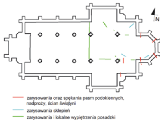
Rys. 6. Uszkodzenia powstałe w wyniku bieżącej eksploatacji górniczej
