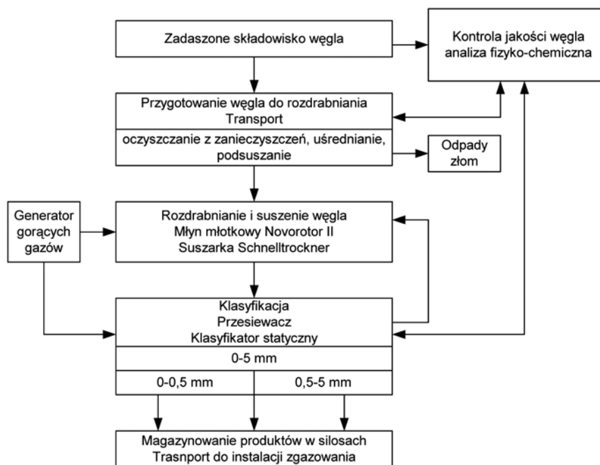
Rys. 10. Schemat blokowy technologii przygotowania węgla kamiennego o uziarnieniu < 5 mm do procesu zgazowania [19]
