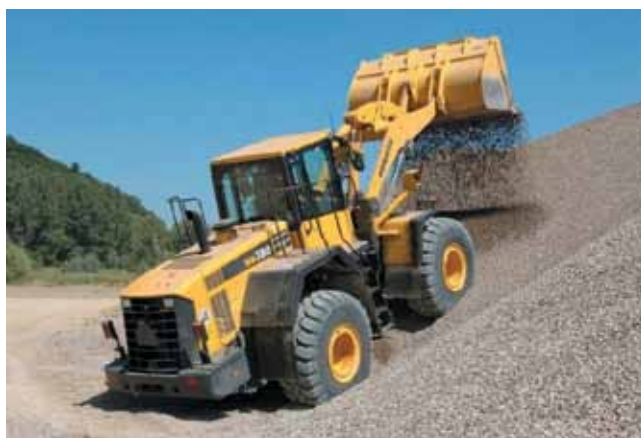
Rys. 2. Praca ładowarki łyżkowej Komatsu WA380-6 [11]
