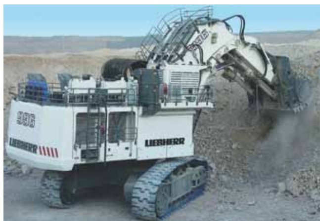
Rys. 1. Urabianie mechaniczne koparką nadsiębierną Liebherr R 996 B [12]
