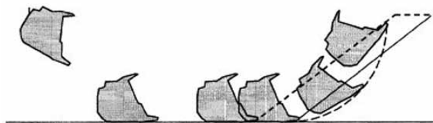
Rys. 6. Proces napełniania łyżki ładowarki [4]
