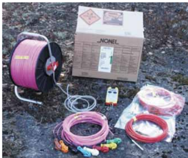
Rys. 4. Elementy systemu inicjacji NONEL UNIDET [11] Fig. 4. Initiation system components of the NONEL UNIDET [11]
