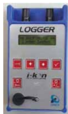
Rys. 9. Urządzenie logujące – i-kon Logger [5, 9] Fig. 9. i-kon Logger – the logging device [5, 9]
