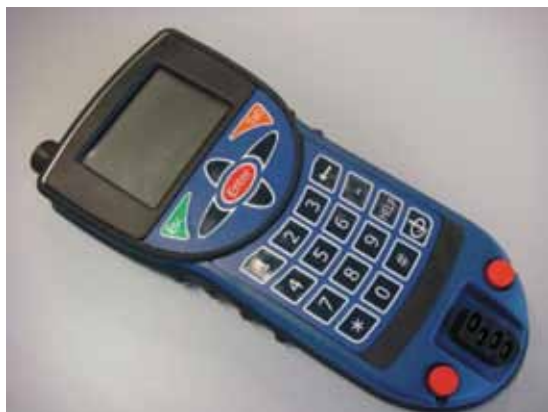
Rys. 7. Urządzenie logujące HotShot Tagger [10] Fig. 7. HotShot Tagger – the logging device [10]
