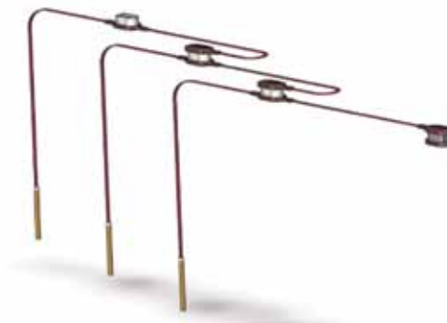
Rys. 6. Schemat wykonywania połączenia zapalników w systemie HotShot [10]
