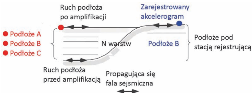
Rys. 1. Schemat pionowej propagacji drgań z głębi podłoża na jego powierzchnię Fig. 1. Scheme of the vertical wave propagation from bedrock to surface
