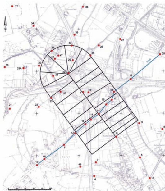
Rys. 8. Ściana „zwrotna” 236 kopalni Niederberg w pokładzie Finefrau pod skrzyżowaniem Moers autostrad A57 i A40 [7] Fig. 8. "Return" wall 236 of Niederberg mine in the seam Finefrau under the Moers intersection on A57 and A40 highways [7]
