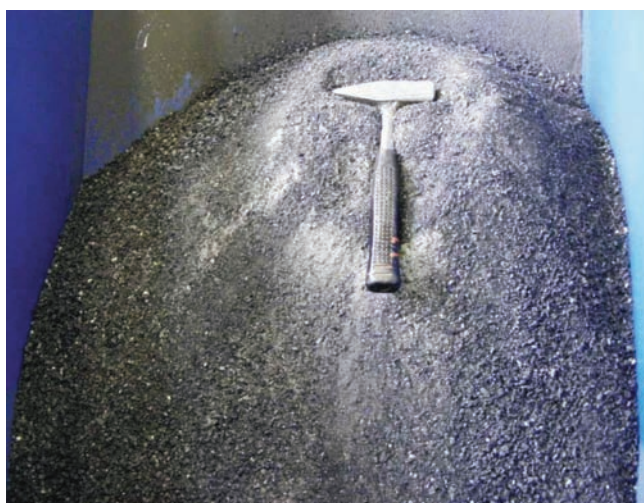
Rys. 4. Produkt 0-4 mm wytworzony z odpadów przeróbczych z KWK „Mysłowice-Wesoła” (fot. J. Szlugaj)
