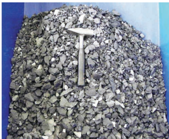
Rys. 3. Mieszanka mineralna 4-31,5 mm wytworzona z odpadów przeróbczych z KWK „Mysłowice-Wesoła” (fot. J. Szlugaj)
