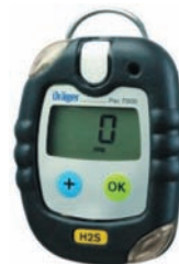
Rys. 3. Elektroniczny analizator gazów Fig. 3. Electronic gas analyser
