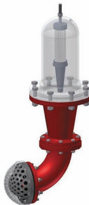
Rys. 2. Widok 3D gaśnicy testowej o objętości 10 dm 3 [5]
