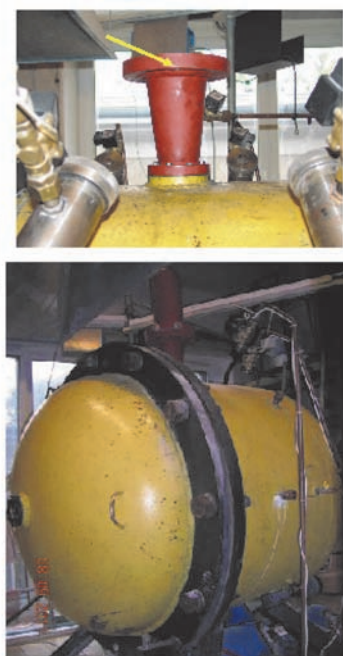
Rys. 3. Schemat i widok stanowiska badawczego z komorą wybuchową o objętości 1,3 m 3 i zamontowaną gaśnicą o objętości 5 dm 3 [5], [2]
