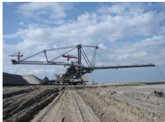
Rys. 3. Maszyny podstawowe w kopalniach węgla brunatnego: a) koparka wielonaczyniowa kołowa, b) zwałowarka
