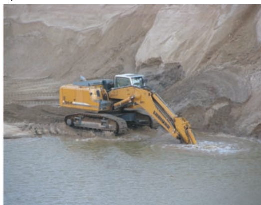
Rys. 4. Przykłady technologii wydobycia kruszyw żwirowo-piaskowych spod wody: a) pływającą pogłębiarką chwytakową, b) koparką jednonaczyniową z ładu
