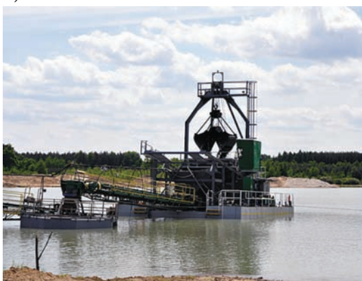
Rys. 4. Przykłady technologii wydobycia kruszyw żwirowo-piaskowych spod wody: a) pływającą pogłębiarką chwytakową, b) koparką jednonaczyniową z ładu
