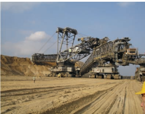
Rys. 3. Maszyny podstawowe w kopalniach węgla brunatnego: a) koparka wielonaczyniowa kołowa, b) zwałowarka
