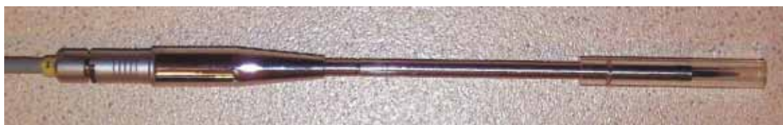
Rys. 5. Czujnik pomiarowy 3D Fig. 5. 3D hot-wire probe
