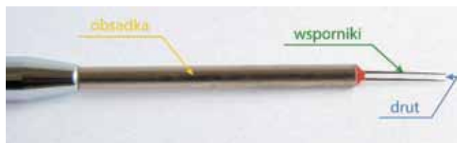
Rys. 4. Czujnik termooanemometryczny jednowłóknowy Fig. 4. Single-wire hot-wire anemometer
