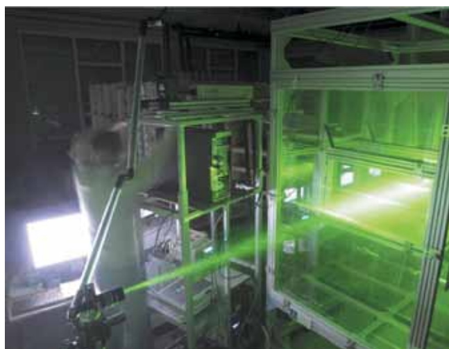
Rys. 2. Przygotowanie zestawu PIV do pomiarów Fig. 2. Setup of the PIV measurement set
