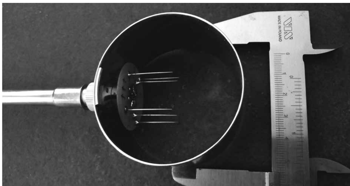
Rys. 5. Prototypowa sonda pomiarowa dla metody znaczników termicznych
