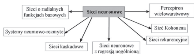
Rys. 2. Sieci neuronowe wykorzystywane w predykcji [2] Fig. 2. Neural networks used in prediction [2]
