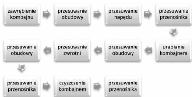
Rys. 1. Mapa procesu dla technologii jednokierunkowego urabiania kombajnem
