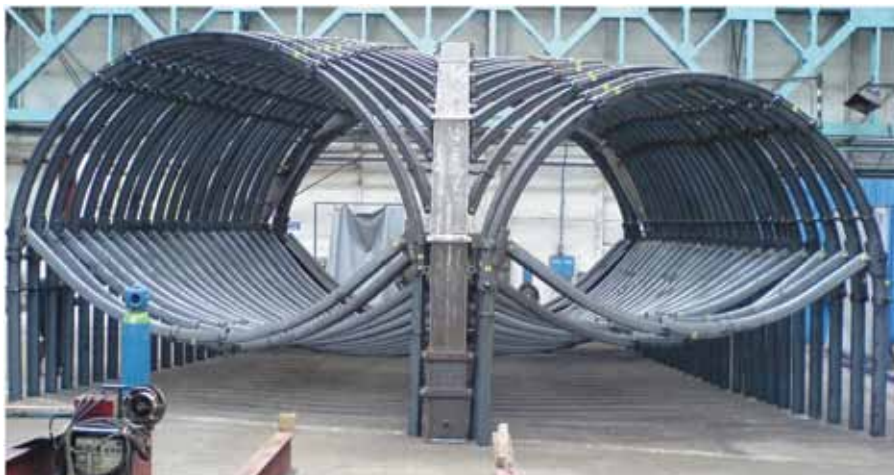
Rys. 12. Obudowa odgałęzienia R52 w trakcie montażu próbnego. Spągnice podniesione w stosunku do planowanego usytuowania w wyrobisku dla umożliwienia montażu próbnego. Fig. 12. Support of the branch R52 during the test assembly. Sill pieces raised in relation to the planned location in the excavation to enable the test assembly
