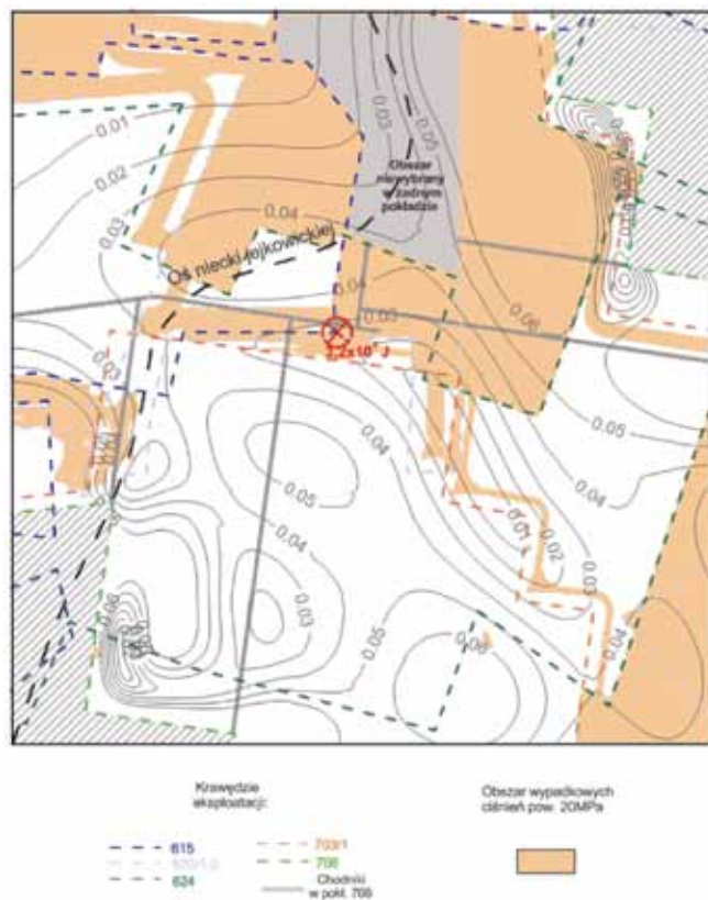
Rys. 7 Izoliny krzywizn deformacji piaskowca zalegającego w odległości około 14 m nad pokładem 706 i 706+707/1-2 na tle obszarów ciśnień wypadkowych oddziaływania krawędzi nadległych pokładów 615 i 625
