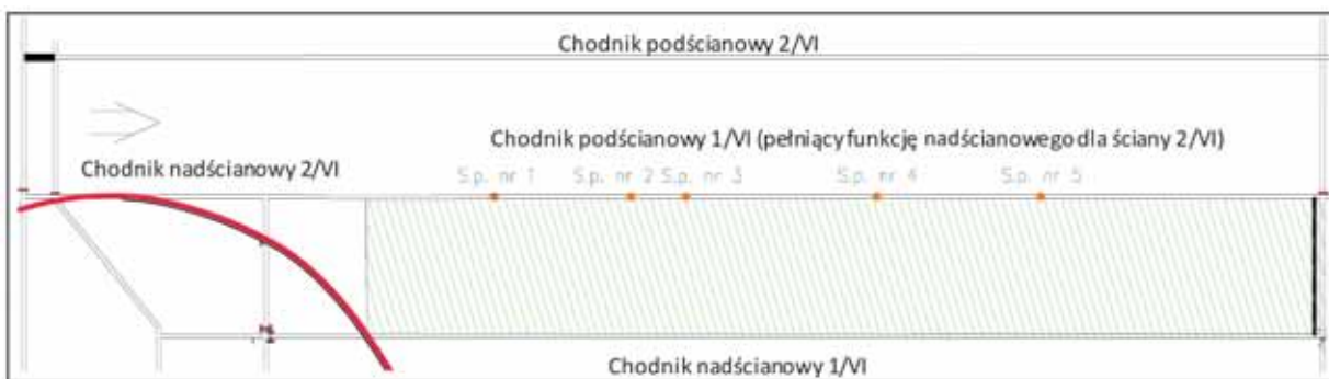
Rys. 2. Rozmieszczenie stanowisk badawczych względem wybiegu ściany w chodniku podścianowym 1/VI (spełniający funkcję nadścianowego)
