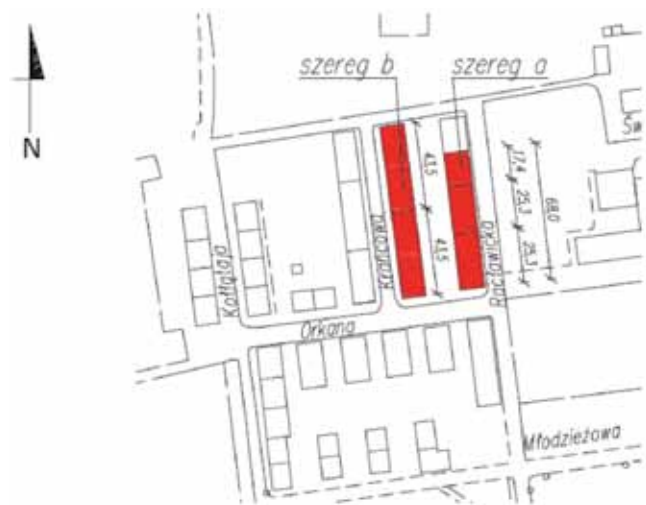
Rys. 1. Podział szeregów na segmenty i ich długości Fig. 1. Division of segments series and their lengths
