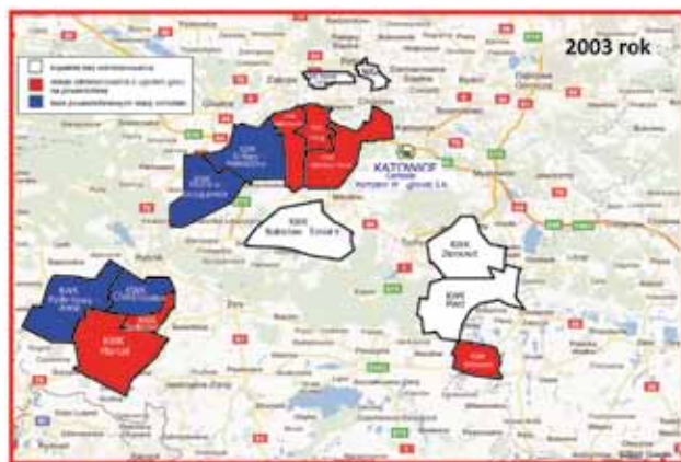
Rys. 8. Lokalizacja stacji odmetanowania umożliwiających ujmowanie metanu na powierzchnię w kopalniach Kompanii Węglowej S.A. a – według stanu na 2003r. oraz b – I kwartał 2014 r.
