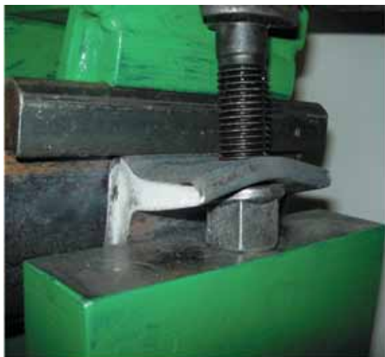
Rys. 3. Stan deformacji jarzm dolnych strzemienia SDO29 – a; i SDO29w – b Fig. 3. Deformation level of lower yokes of the stirrup SDO29 (a) and SDO29w (b)
