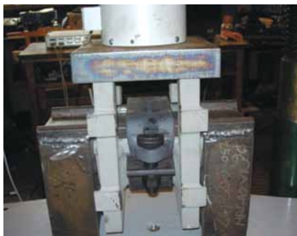
Rys. 4. Przyrząd do badania strzemion na rozciąganie z zamontowanym strzemieniem SDO29
