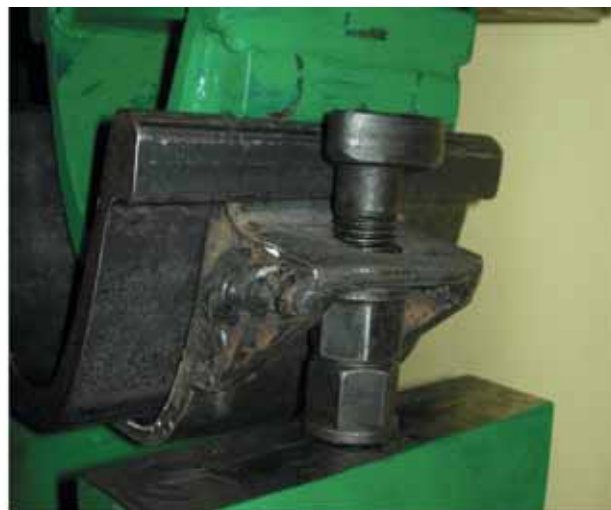
Rys. 3. Stan deformacji jarzm dolnych strzemienia SDO29 – a; i SDO29w – b Fig. 3. Deformation level of lower yokes of the stirrup SDO29 (a) and SDO29w (b)
