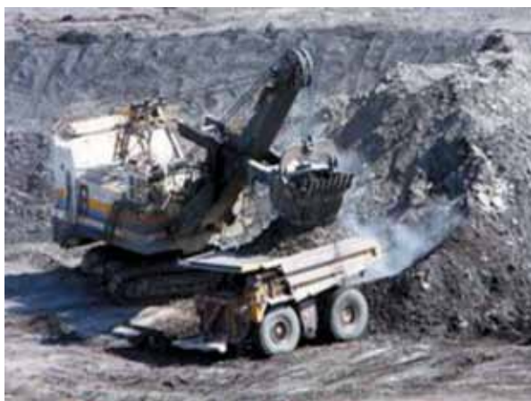
Rys. 5. El Cerrejón: koparka linowa ładująca na wozidła Fig. 5. El Cerrejón: power shovel loading dumper trucks
