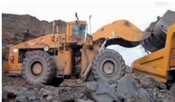
Rys. 10. Ładowarka łyżkowa Fig. 10. Bucket wheel loader
