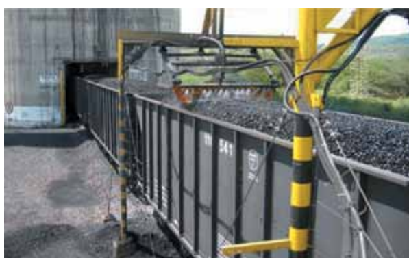
Rys. 8. Zwilżanie węgla przed transportem Fig. 8. Wetting coal prior to transport
