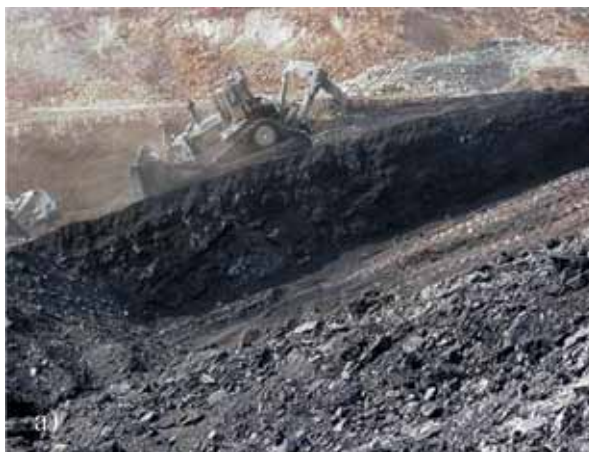
Rys. 4a i b. El Cerrejón: spycharko-zrywarki kruszące węgiel Fig. 4a and b. El Cerrejón: bulldozer-ripper crushing coal
