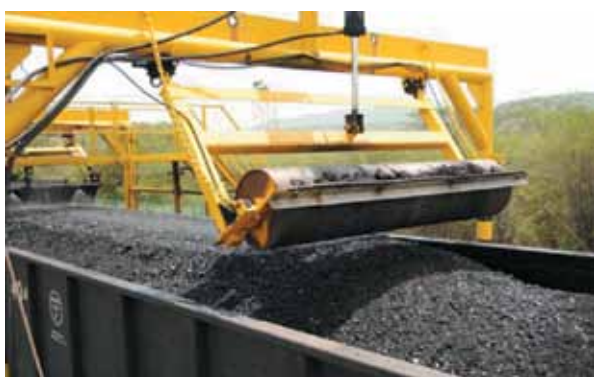
Rys. 7. Wyrównywanie węgla po załadunku Fig. 7. Levelling coal after loading
