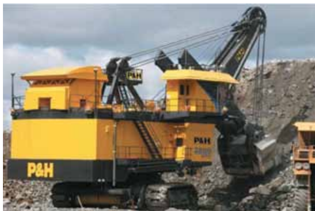
Rys. 3. Łyżkowa koparka linowa P&H 2800XPC Fig. 3. P&H 2800XPC bucket excavator
