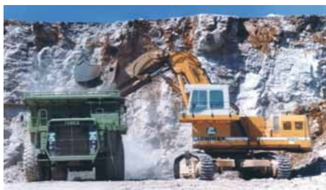
Rys. 5. Boczny załadunek wozidła technologicznego przez hydrauliczną koparkę nadsiębierną łyżką o zamknięciu kłapowym w kopalni odkrywkowej surowców skalnych Fig. 5. Lateral loading of the off-highway dump track by hydraulic mining shovels
