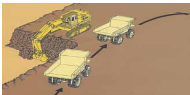
Rys. 4. Sposób załadunku wozideł technologicznych przy potokowym sposobie podjazdu przez koparkę jednonaczyniową podsiębierną (bardzo niekorzystny przypadek – duża wysokość podnoszenia urobku) [3] Fig. 4. Method of loading of the off-highway dump trucks by backhoe excavator (unfavourable case – lifting of output takes place very high)
