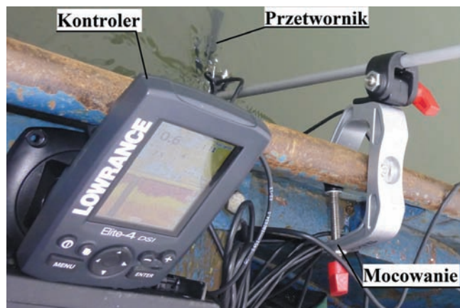
Rys. 4. Sonda akustyczna Lowrance Elite-4 DSI wykorzystana w pomiarach batymetrycznych (Fot. D. Madusiok)
