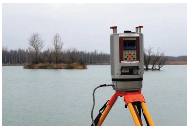
Rys. 3. Skaner Riegl VX 400 w czasie skanowania wyspy (Fot. D. Madusiok)
