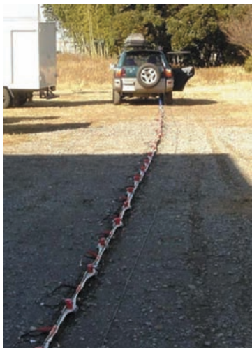
Rys. 3. Taśmowa konstrukcja strimera sejsmicznego LS-1 produkcji Geostuff [24]
