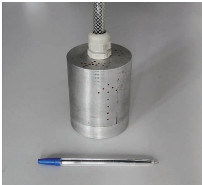
Rys. 7. Widok trójskładowego czujnika przyspieszenia drgań, skonstruowanego na bazie przetworników akcelerometrycznych z wyjściem typu DeltaTron 457-005B (0,4 Hz – 6 kHz) produkcji Brüel&Kjær
