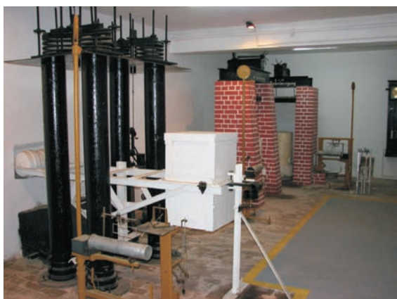
Rys. 4. Sejsmograf Mainki znajdujący się w Obserwatorium Geofizycznym Polskiej Akademii Nauk w Raciborzu [19]
