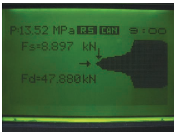
Rys. 5. Wyświetlacz POP-1 z wartościami sił oraz ciśnienia
