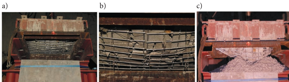
Rys. 10. Siatka zaczepowa (dwie siatki ułożone obok siebie) w stanowisku badawczym a – przed badaniem, b – podczas badania, c – po badaniu
