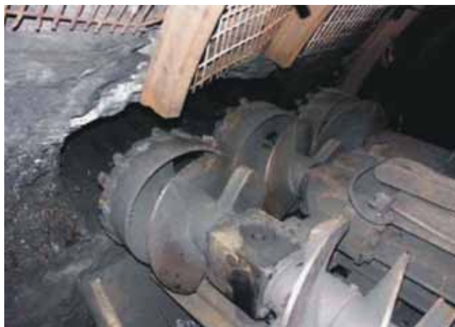
Rys. 6. Widok głowic zwierających przy ociosie węglowym [5] Fig. 6. View of drilling heads by the coal sidewall [5]
